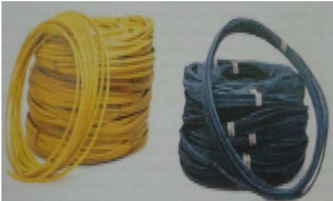
Σχήμα2-6: Βραδύκαυστη ή θρυαλλίδα ασφαλείας.
