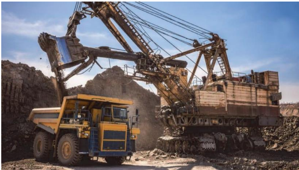
Εικόνα 3.4.6: Φτυάρι καλωδίων που πραγματοποιεί φόρτωση σε φορτηγό έλξης.
