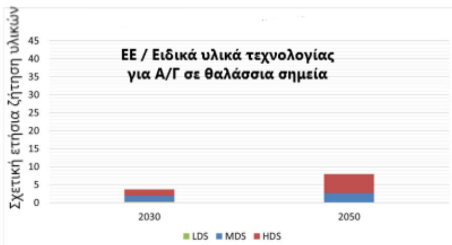
Σχήμα 3.8: Ετήσια ζήτηση ειδικών υλικών τεχνολογίας για Α/Γ για το έτος 2018 (σε τόνους/έτος) στην ΕΕ (Πίνακας αριστερά). Σχετική ζήτηση για τα έτη 2030 και 2050 ως λόγος προς την ζήτηση του έτους βάσης (Διαγράμματα δεξιά: πάνω συνολικές τιμές, στη μέση για Α/Γ ξηράς και κάτω για Α/Γ σε θαλάσσια σημεία).
