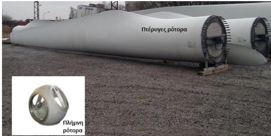
Εικόνα 3.1: Πτέρυγες και πλήμνη ρότορα
