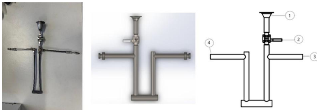
Εικόνα 4.1 : Πειραματικός Αντιδραστήρας Αεριοποίησης Σταθερής Κλίνης
