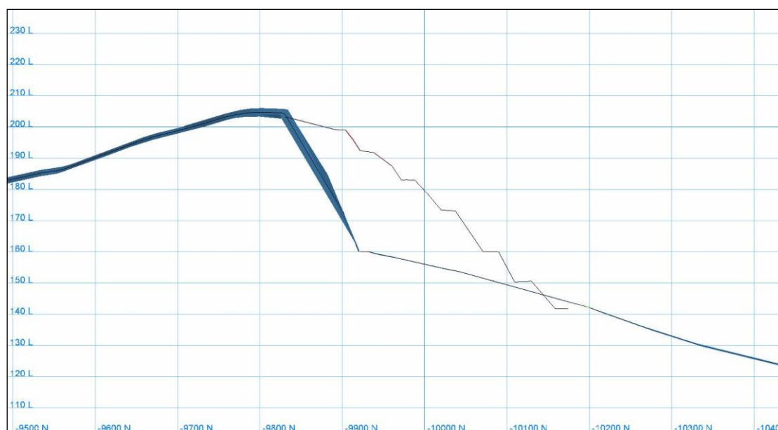
Σχήμα 7.5: Τομή στο μέσο της κατολίθησης όπου φαίνονται οι ανακατασκευασμένες βαθμίδες και ο όγκος που υπολογίζεται.
