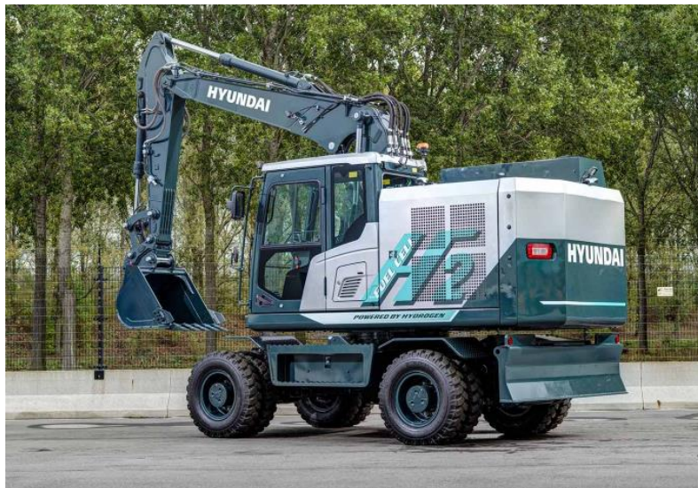
Εικόνα 4.8 Εκσκαφέας υδρογόνου Hyundai HW155H
