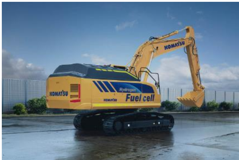
Εικόνα 4.6 Υδραυλικός Εκσκαφέας υδρογόνου της Komatsu.
