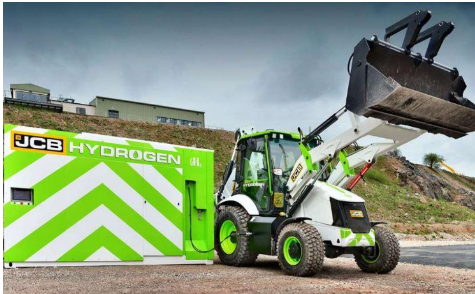
Εικόνα 4.3 Εκσκαφέας Υδρογόνου της JCB μπροστά και πίσω μονάδα ανεφοδιασμού καυσίμου.
