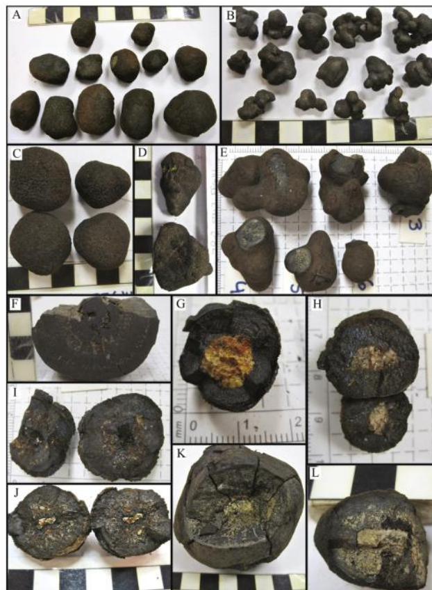
Εικόνα 2.8: Πολυμεταλλικοί σβόλοι (Πηγή: Critical metals in manganese nodules from the Cook Islands EEZ, abundances and distributions )
