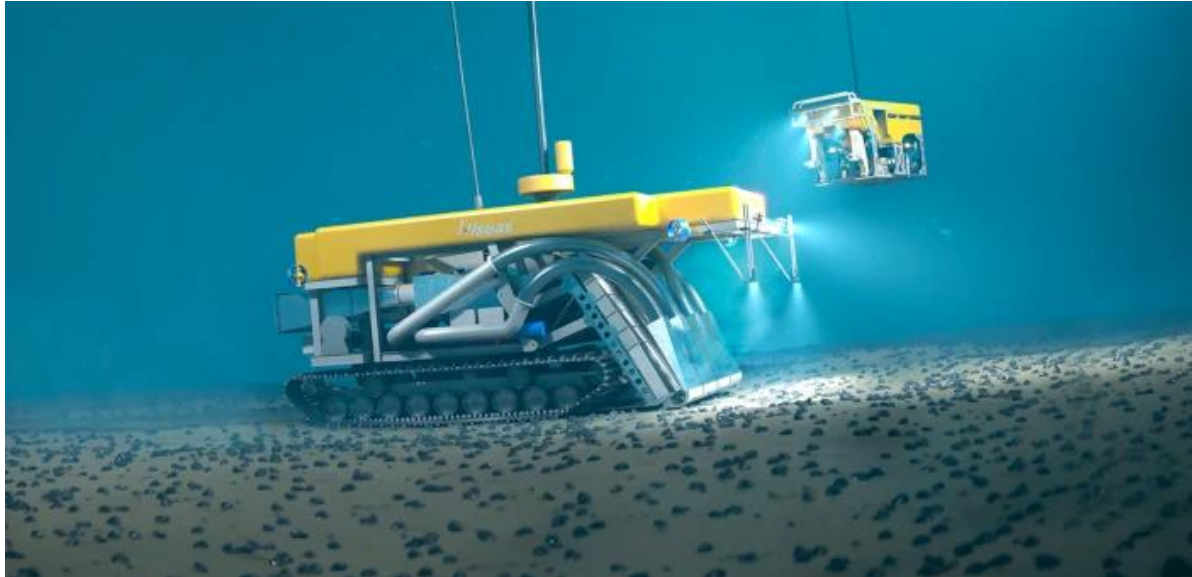
Εικόνα 5.3 Υποθαλάσσιος Συλλέκτης (Πηγή: https://deepseamining.ac/deep_sea_mining_equipment#gsc.tab=0 )
