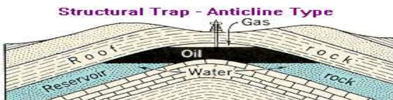
Εικόνα 13: Πιθανές δομικές παγίδες κάτω από την επιφάνεια σε πετρώματα ταμιευτήρα. Πηγή: (Louisiana Government, 2000)
