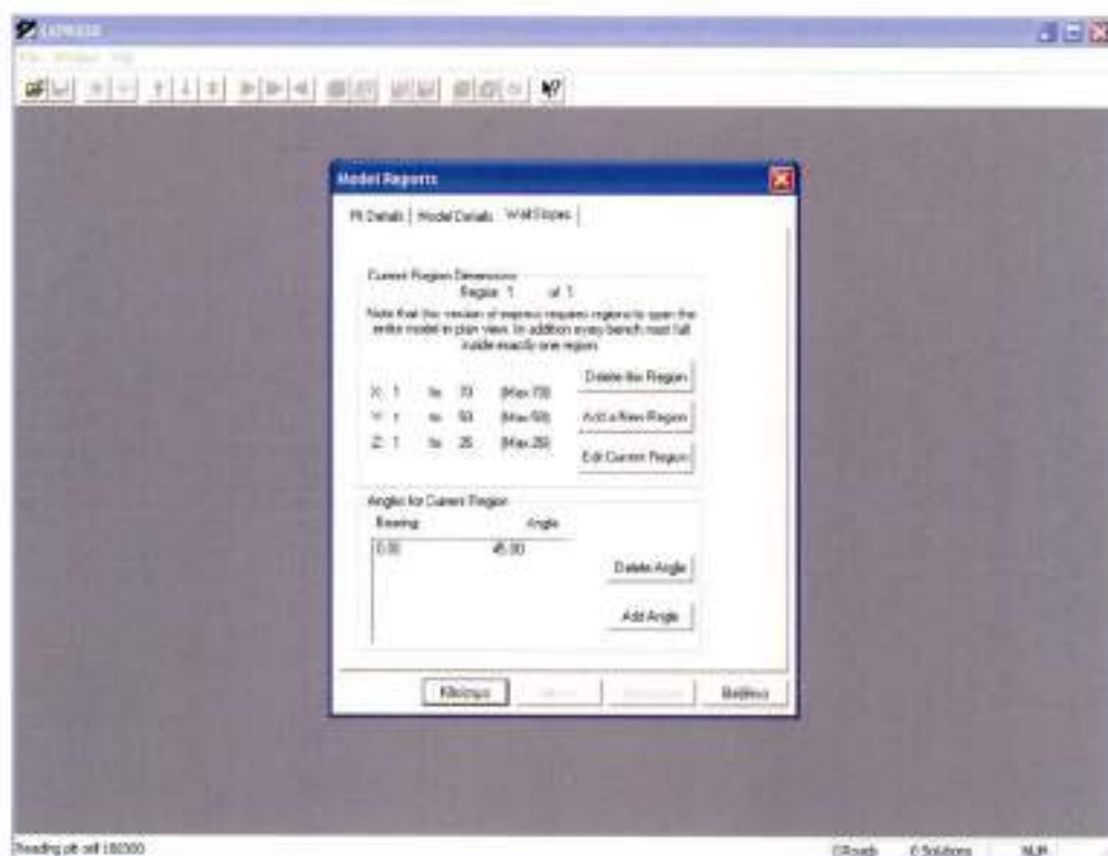
Εικόνα 35: Επιλογές σχετικά με την κλίση των βαθμίδων της εκμετάλλευσης.
